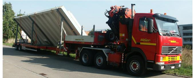
**Beide Aufliegerachsen sind unabhängig lenkbar, dadurch ist man trotz der Länge sehr wendig.**
